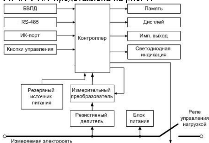
Рис. 7 – Структурная схема УТО-01Ф101.
