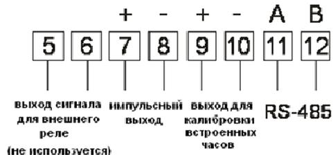
Рисунок 3- Дополнительные контакты клеммной колодки
